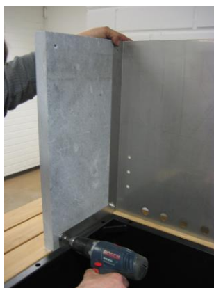
16. Asenna sivukivet ja takapelti alaruuveilla kiinni runkoon
